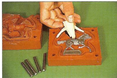
**10** Pour démouler, retirez les tiges de métal en poussant sur les extrémités, glissez une pointe dans le plan de joint et faites levier. Retirez la pâte à modeler de la tige de coulée.
