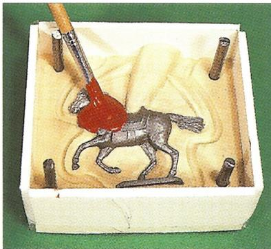
**1** Noyez à demi le modèle dans de la pâte à modeler, puis creusez un petit canal sur le plan de joint et placez la tige de coulée et les événements. Enfoncez éventuellement dans la pâte des petites tiges de centrage en métal dont la hauteur correspond à l'épaisseur finale du moule.
